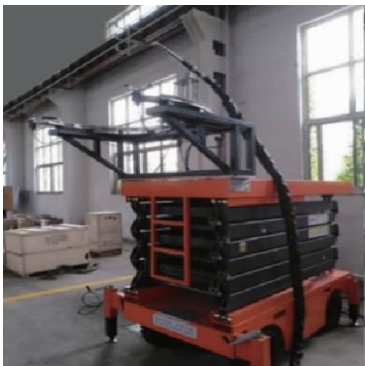
(b) 升降旋转支架和干冰喷头
